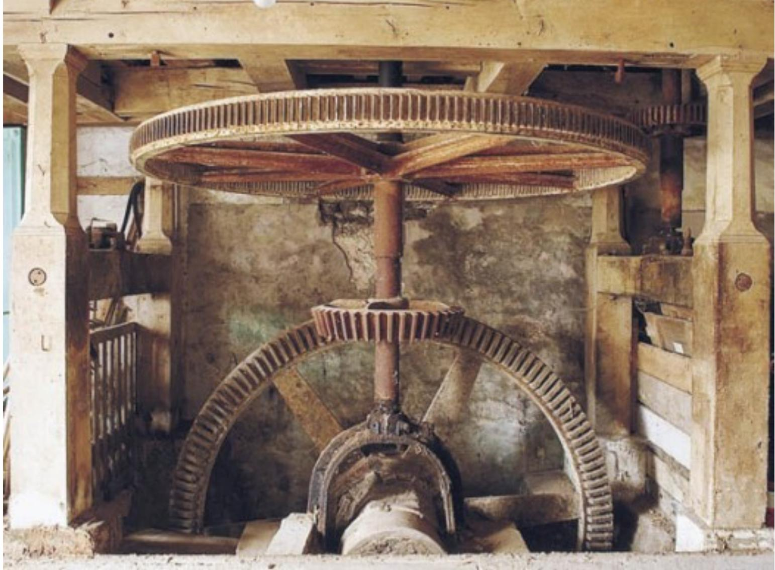
Modèle d'engrenage vertical avec la meule à l'étage : l'embrayage à droite.
