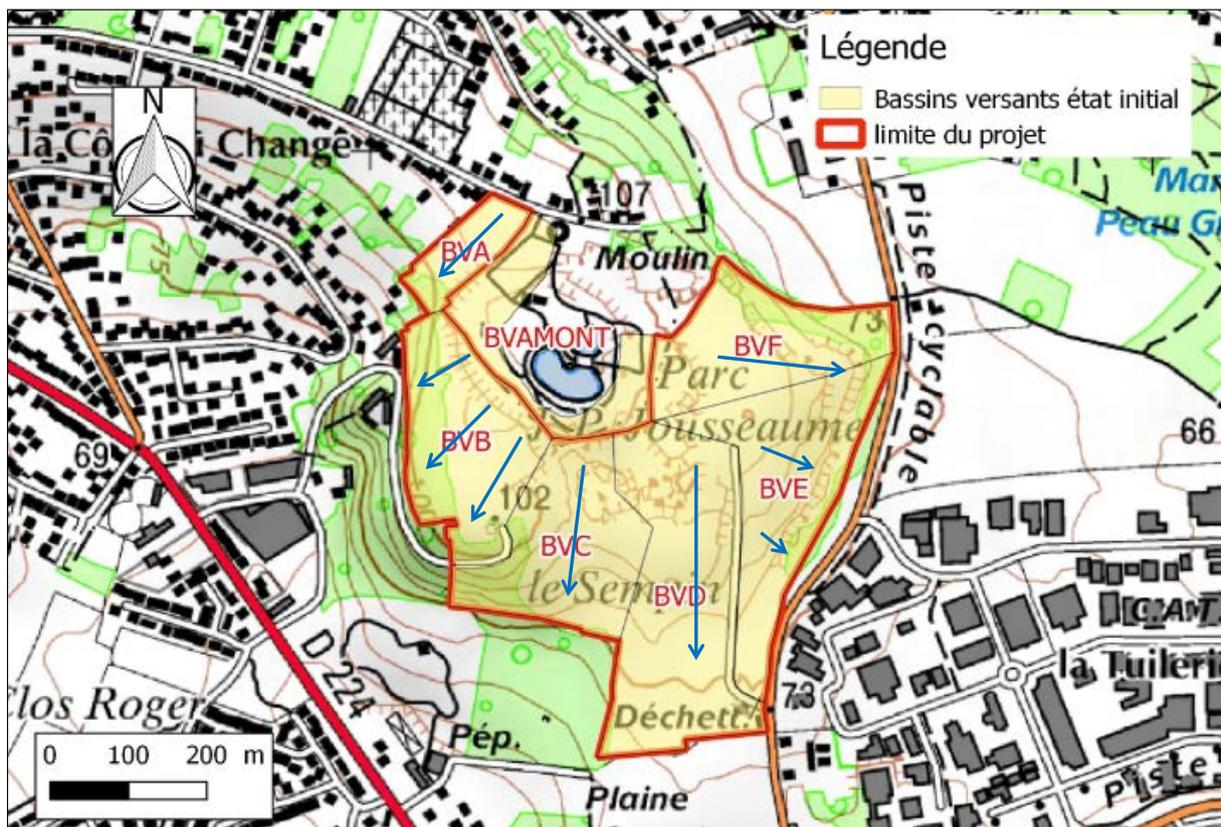
Figure 43 : Bassins versants actuels et sens d'écoulements principaux (Source : BURGEAP, 2017)
