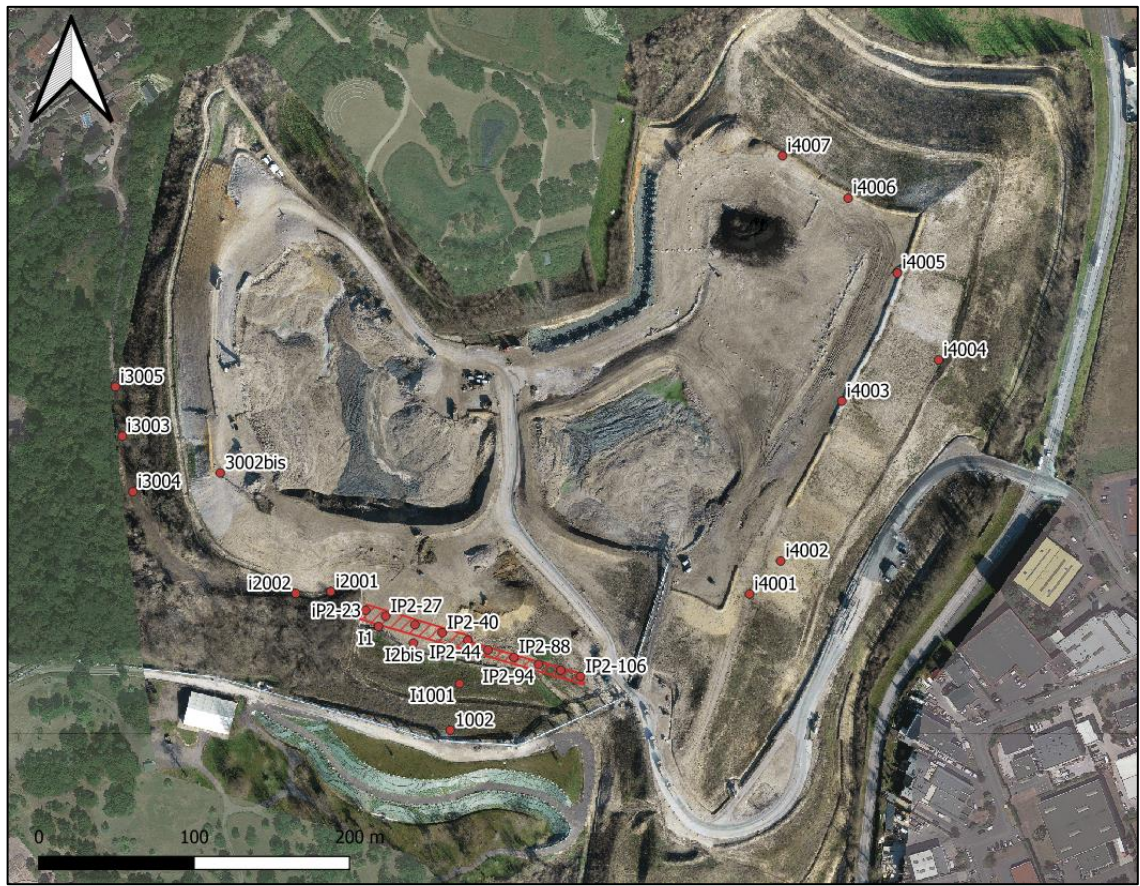
Figure 8 : Implantation des inclinomètres qui sont encore fonctionnels sur le site de Chelles, et seront conservés à la fin du projet
