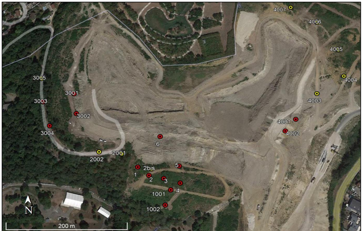
Figure 7 : Localisation des inclinomètres suivis sur le site de Chelles
