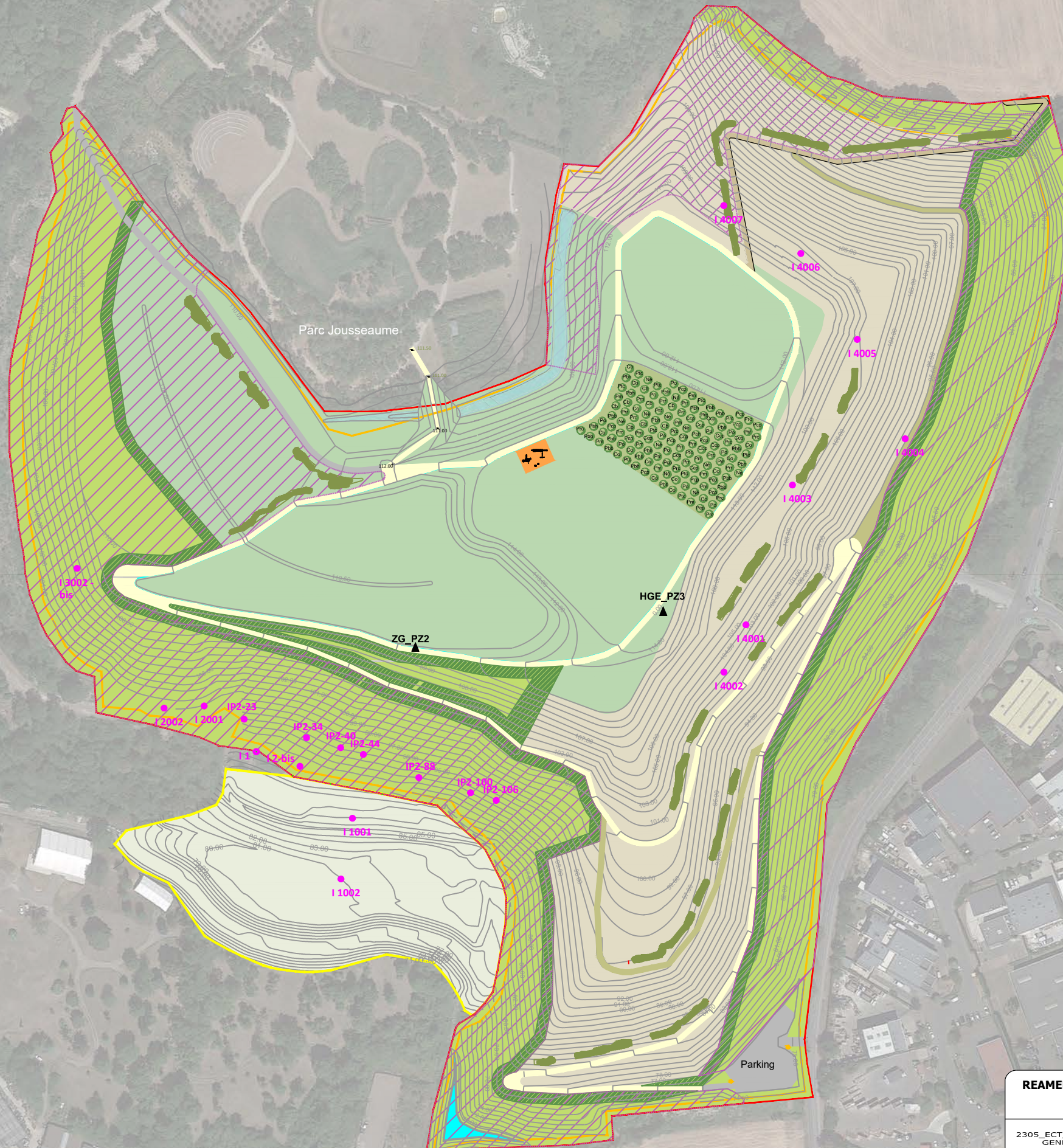
Figure 2 : Plan de localisation des piézomètres et inclinomètres conservés
